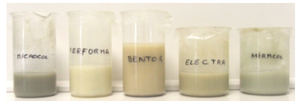
Figure 1. Efficacité de 5 bentonites apportées à la dose de 20 g/hl - Évaluation de l'instabilité protéique par le test à la chaleur sur un moût Rosé – essai 2005, Centre du Rosé – IFV.
